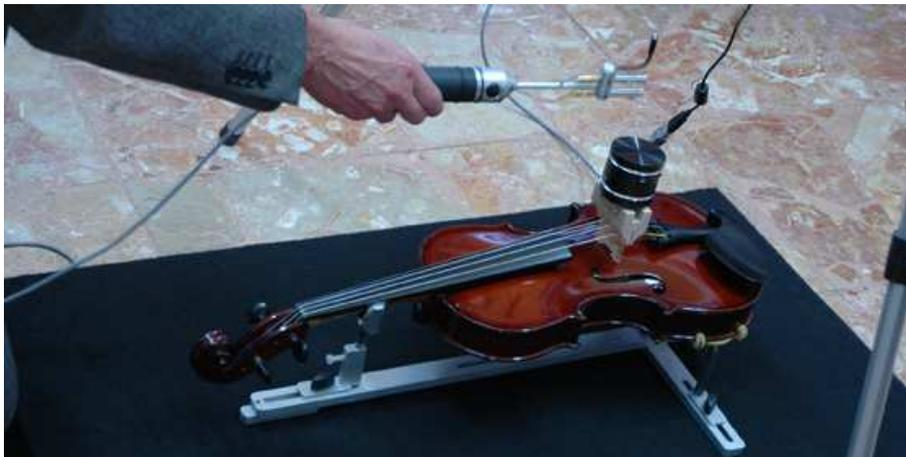
Foto 6 – Sonda intensimetrica p-p con puntatore ad infrarossi per riferire il livello di intensità misurato alla posizione della sonda che verrà spostata in prossimità della tavola
