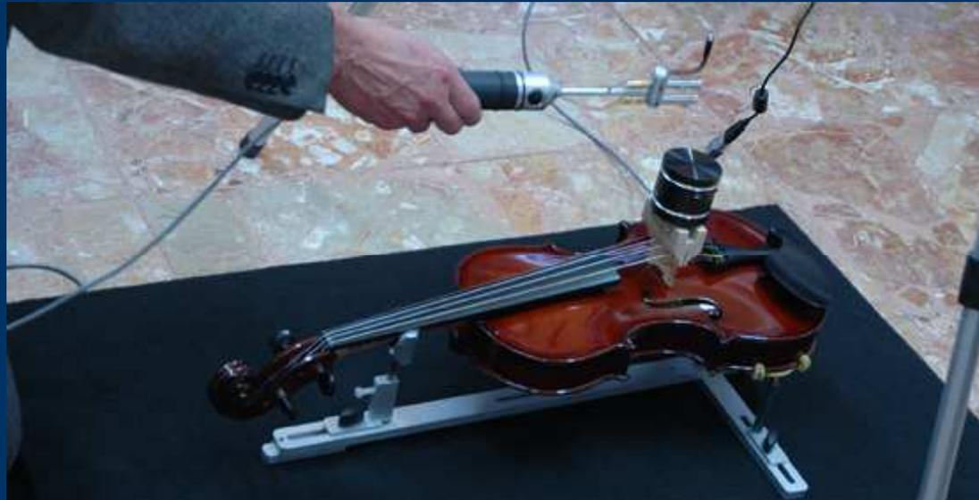
*Sonda intensimetrica p-p con puntatore ad infrarossi per riferire il livello di intensità misurato alla posizione della sonda che verrà spostata in prossimità della tavola*
