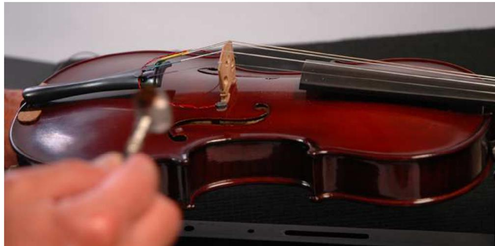
**Con il martelletto attrezzato con trasduttore di forza si percuote, in successione, la tavola armonica nei nodi della griglia. Il sistema di analisi, in fase di acquisizione, mostra in continuo la risposta all'impulso, la funzione di trasferimento e, soprattutto, la funzione di coerenza. Si possono portare correzioni se l'eccitazione impulsiva non produce, nella media, una funzione di coerenza appropriata.**
