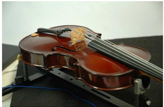
Foto 3 – eccitazione con un trasduttore di forza Foto 4 - Accelerometro posizionato sulla tavola
