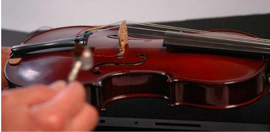
Foto 5 – Sistema di percussione del corpo dello strumento con martelletto attrezzato
