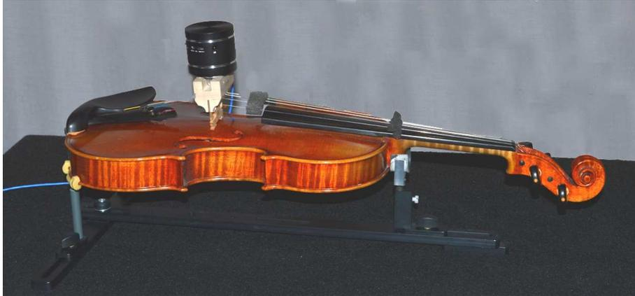
Foto 2 - Sistema di eccitazione del ponticello con mini shaker
