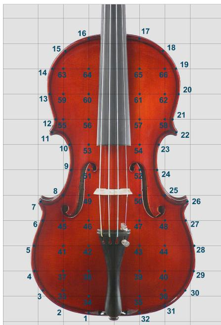
Foto 1 – Griglia di misura, proiettata sullo strumento, per la individuazione dei punti di eccitazione e di risposta.
