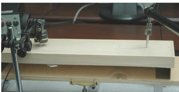
Il calcolatore produce un segnale sinusoidale modulato in frequenza (sine sweep) che pone in vibrazione la tavola (trasduttore di sinistra).
