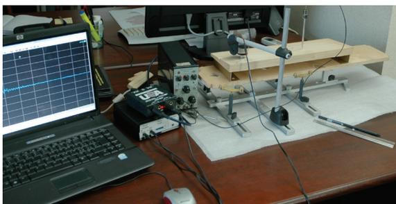
Determinazione delle qualità elastiche dei legni. Le analisi elettroacustiche attraverso la risposta all'impulso (tap tone) consentono di determinare:
