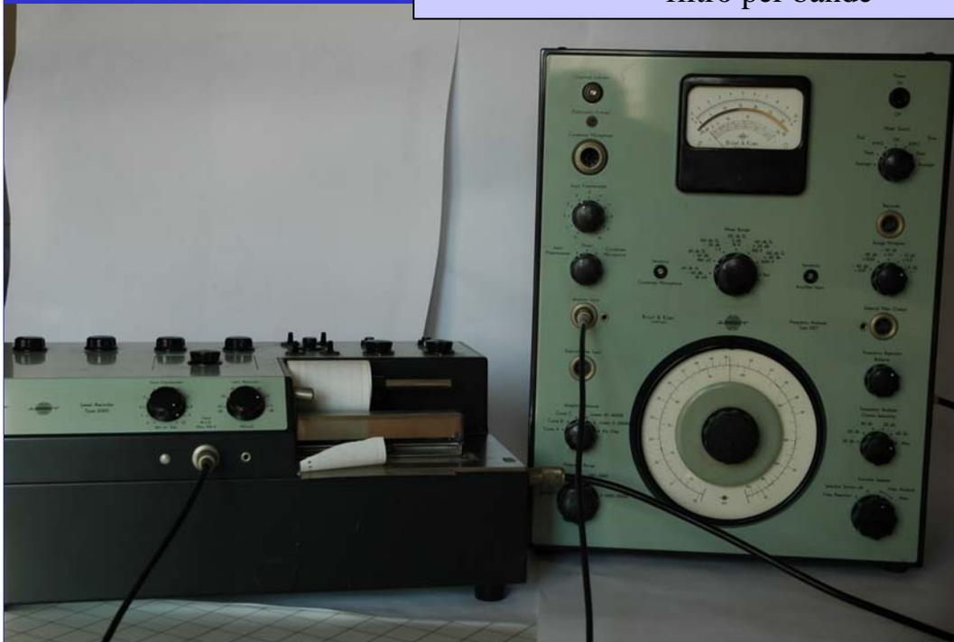
I misuratori di livello sonoro ed i registratori grafici di livello dispongono di una sezione per la misura del vero valore efficace o RMS
