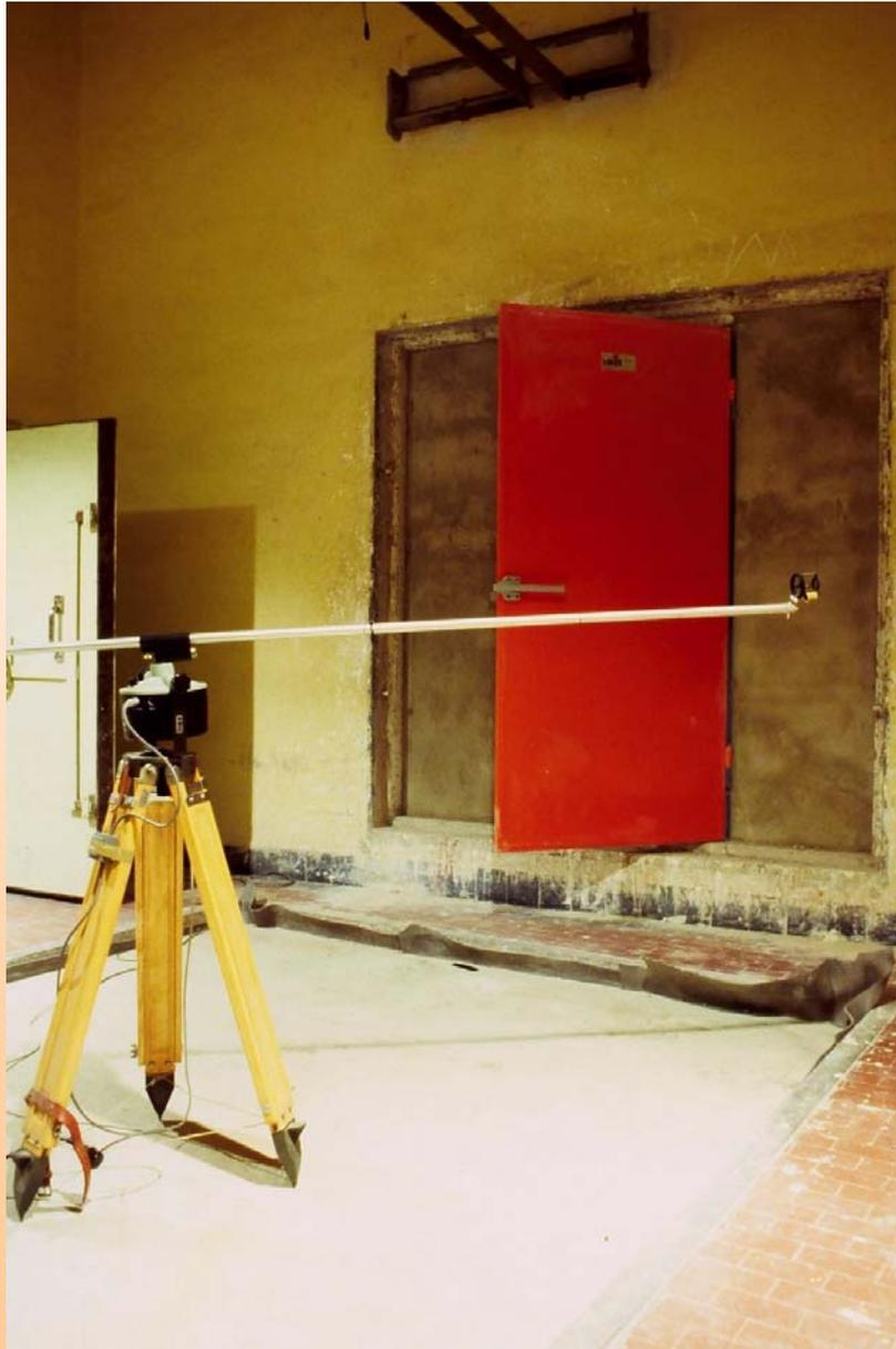
**La misura del potere fonoisolante in laboratorio (Anno 1972 IEN ).**
