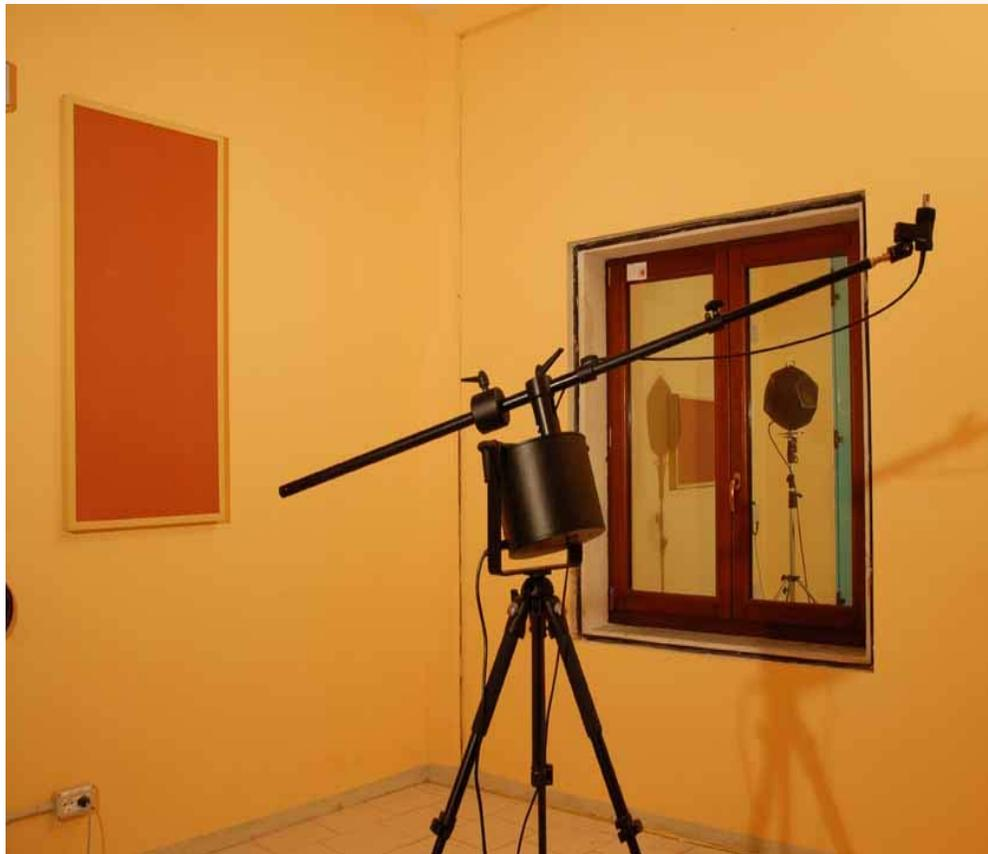
Tipo di apertura oscillo battente in pino di Svezia lamellare, vetro stratificato 44.1(12)33.1
