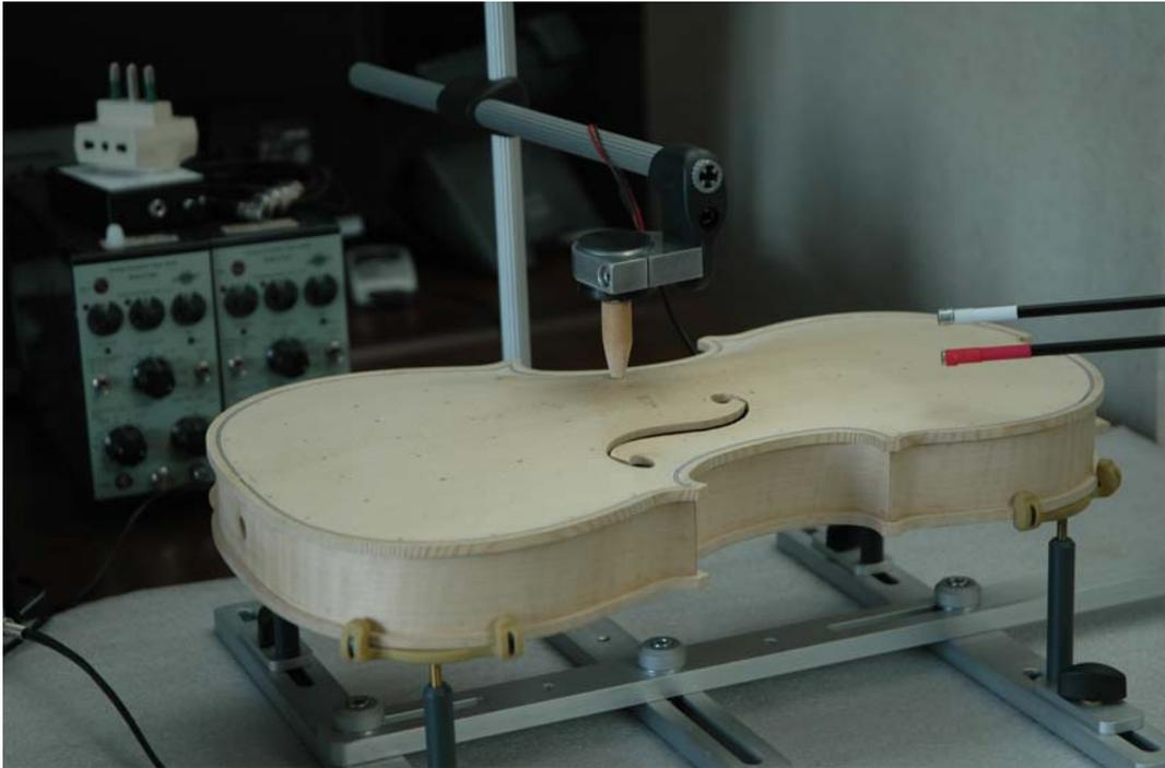
**Foto 8** – La tavola armonica di un corpo di un violino in bianco prima dell'accordatura finale ove si agirà esclusivamente raschiando la superficie esterna.
