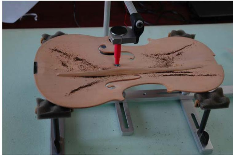
**Foto 5** – *Formazione del modo 2 ( 297 Hz) della tavola armonica mediante eccitazione nel punto di contatto del ponticello. La tavola è sostenuta dal magnete fissato alla bobina mobile dell'eccitatore elettromeccanico*
