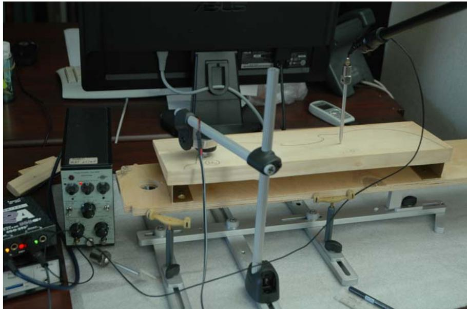
**Foto 3** – La velocità di propagazione dell'onda flessionale si misura attraverso la risposta all'impulso. Un sistema di eccitazione (a sinistra) pone in vibrazione la tavola. Un accelerometro (a destra) rileva le vibrazioni ricavandone la risposta all'impulso. Da essa si deducono le frequenze di risonanza e gli smorzamenti.
