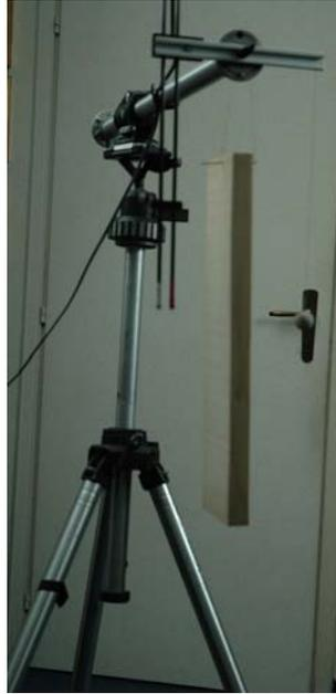
**Foto 2** – Misura della frequenza di risonanza e del fattore di perdita di una tavola grezza che sarà utilizzata per la realizzazione della tavola armonica del violino..
