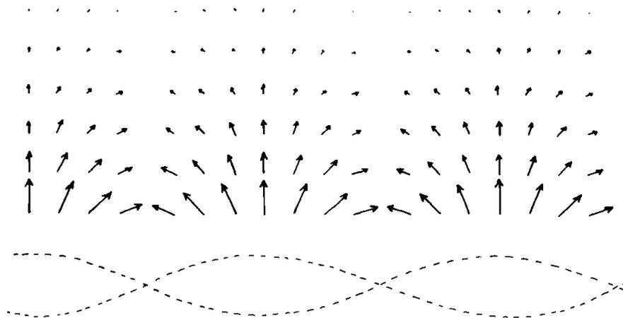
Fig. 3.11 Distribuzione della intensità reattiva nel campo acustico generato da una piastra infinita sede di onde stazionarie. (F.J.FAHY "Sound Intensity")
