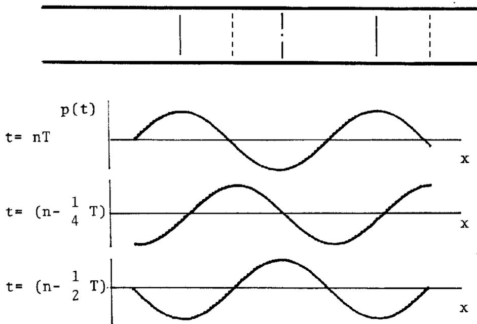
Fig. 2.9 Andamento della pressione acustica lungo il tubo in tre istanti diversi.
