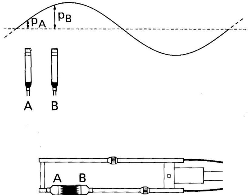
Fig. 6.2 Sonda intensimetrica a gradiente di pressione (Brüel & Kjær Technical review - 1982).
