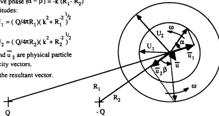
Fig. 3.6 Composizione del moto delle particelle per interferenza di due onde acustiche. Il vettore velocità ruota ruota e le particelle si muovono su traiettorie ellittiche. (F.J.FAHY "Sound Intensity")
