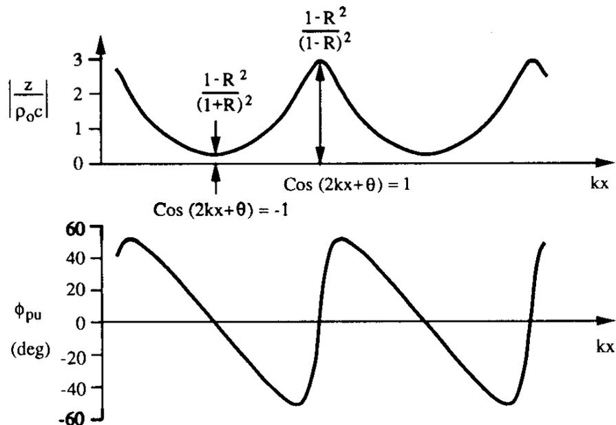
Fig. 3.4 Modulo e fase dell'impedenza acustica specifica normalizzata in un campo d'onde stazionarie . (F.J.FAHY "Sound Intensity")
