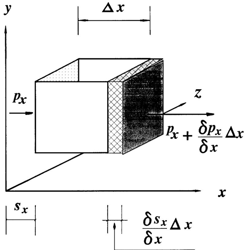
Fig. 2.5 Variazione della pressione acustica sulle due facce del cubo elementare per effetto della deformazione.
