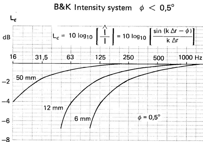
Fig. 6.8 Errore dovuto al disaccoppiamento in fase tra i due microfoni: è molto sentito alle basse frequenze e per una distanza ridotta tra i microfoni (Brüel & Kjær Technical review - 1982).
