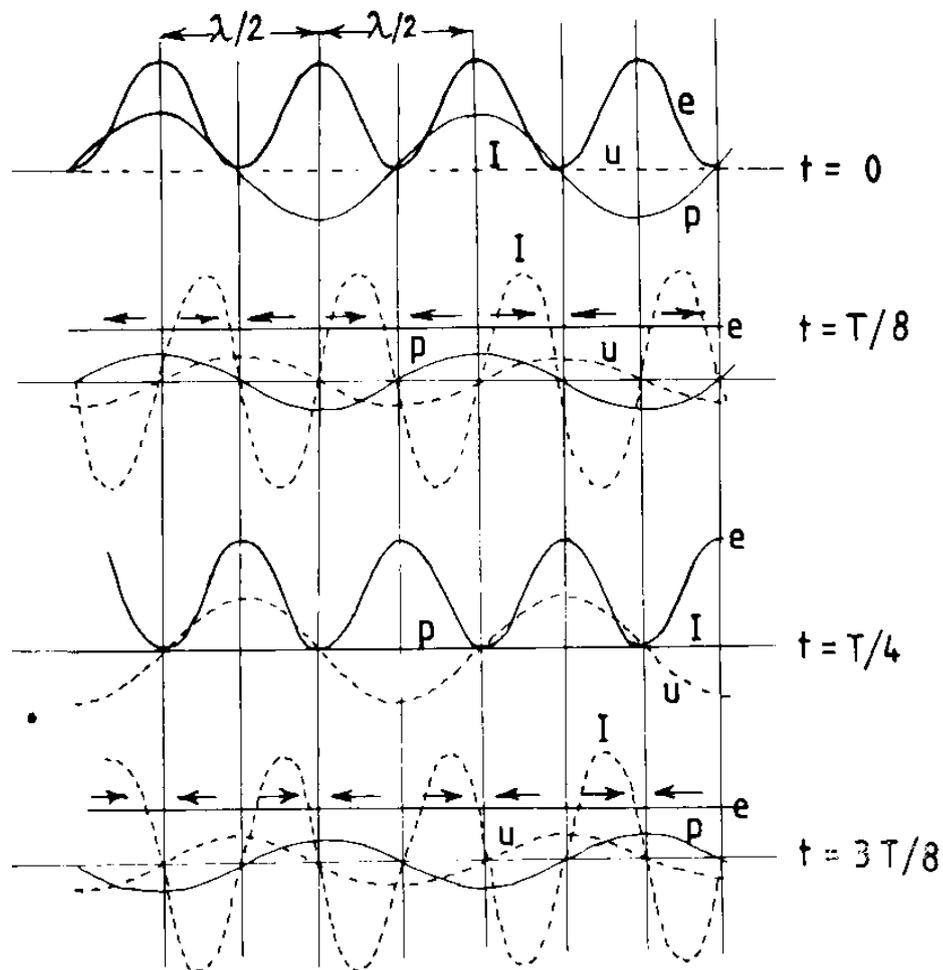
Fig. 3.3 Distribuzione spaziale della pressione, velocità, densità energetica ed intensità acustica di un'onda stazionaria ad intervalli di 1/8 di period. (F.J.FAHY "Sound Intensity")
