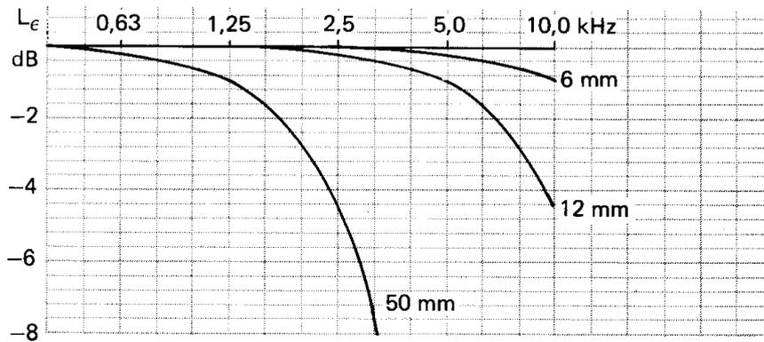
Fig. 6.5 Errore in funzione della massima frequenza e della distanza tra i microfoni (Brüel & Kjær Technical review - 1982)
