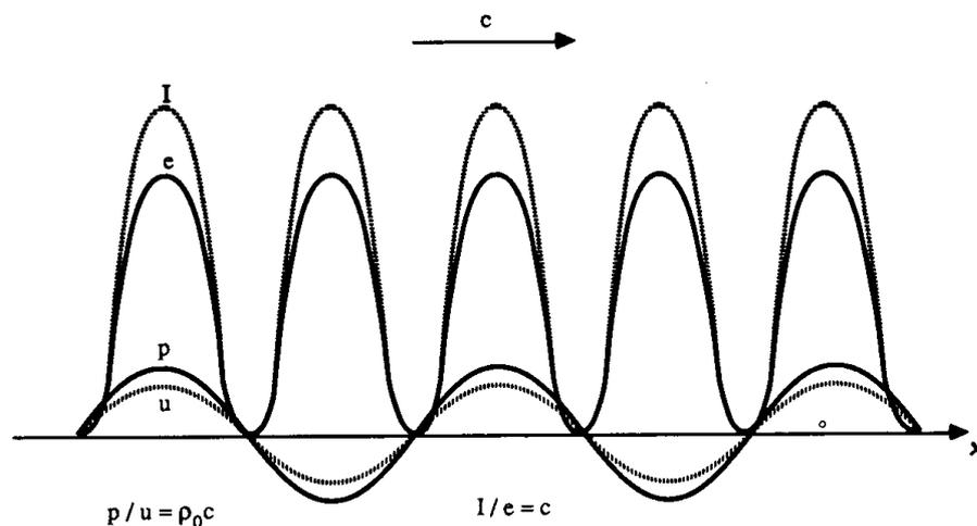
Fig. 3.2 Distribuzione della pressione sonora, velocità acustica, densità d'energia ed intensità per un'onda acustica piana progressiva in un istante lungo la direzione di propagazione. (F.J.FAHY "Sound Intensity")
