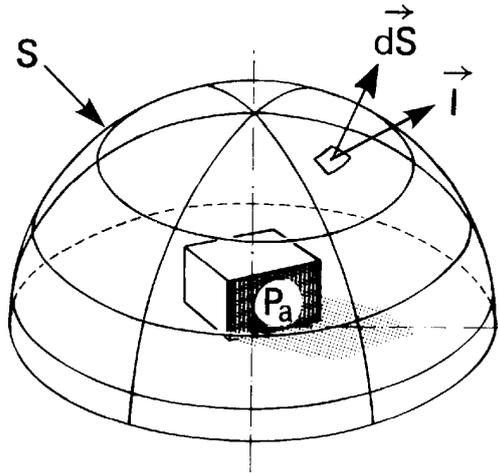
Fig. 5.1 Determinazione della potenza sonora emessa dalla sorgente  $P_a$  per integrazione dell'intensità acustica sulla superficie della semisfera (Brüel & Kjær Technical review - 1982).
