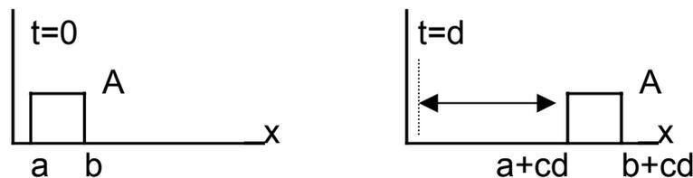
Fig.2.6 Propagazione di un impulso lungo la direzione x
