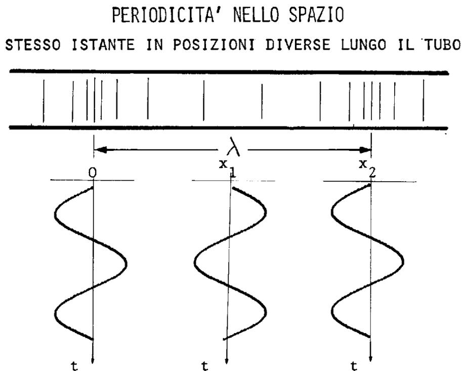
Fig 2.8 Andamento della pressione sonora in funzione del tempo, rilevata contemporaneamente in tre posizioni fisse lungo la direzione  $x$  poste ad una distanza di  $\lambda/2$
