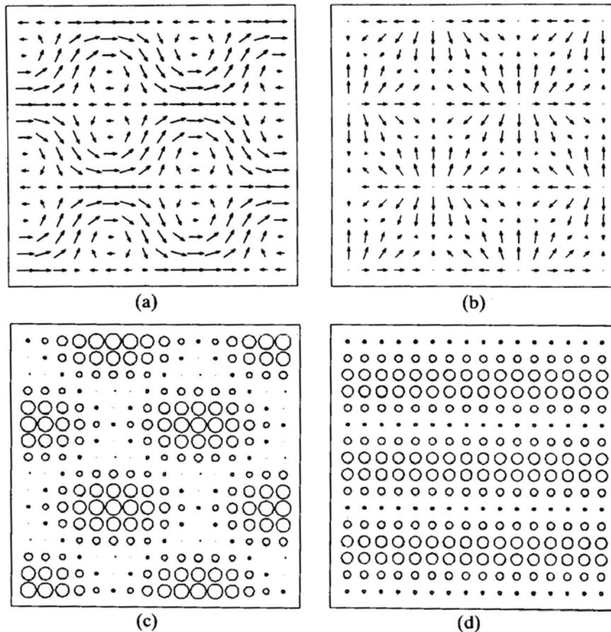
Fig. 3.8 Distribuzione della intensità media (a), dell'intensità reattiva (b), della densità di energia potenziale (c) e della densità di energia cinetica (d) in un campo acustico prodotto dall'interferenza di un'onda piana progressiva ed un campo di onde stazionarie con direzione ortogonale alla prima. (F.J.FAHY "Sound Intensity")
