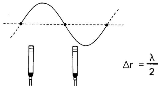
Fig. 6.4 Errore sistematico (BIAS ERROR) dovuto all'approssimazione del gradiente con una misura a distanza finita. L'errore limita verso le alte frequenze il segnale analizzabile (Brüel & Kjær Technical review - 1982).
