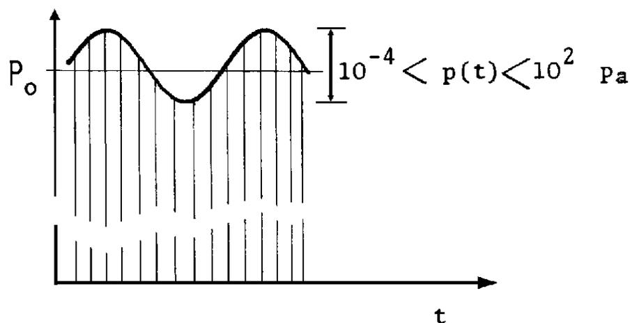
Fig. 2.3 Oscillazione della pressione atmosferica per effetto della pressione acustica.
