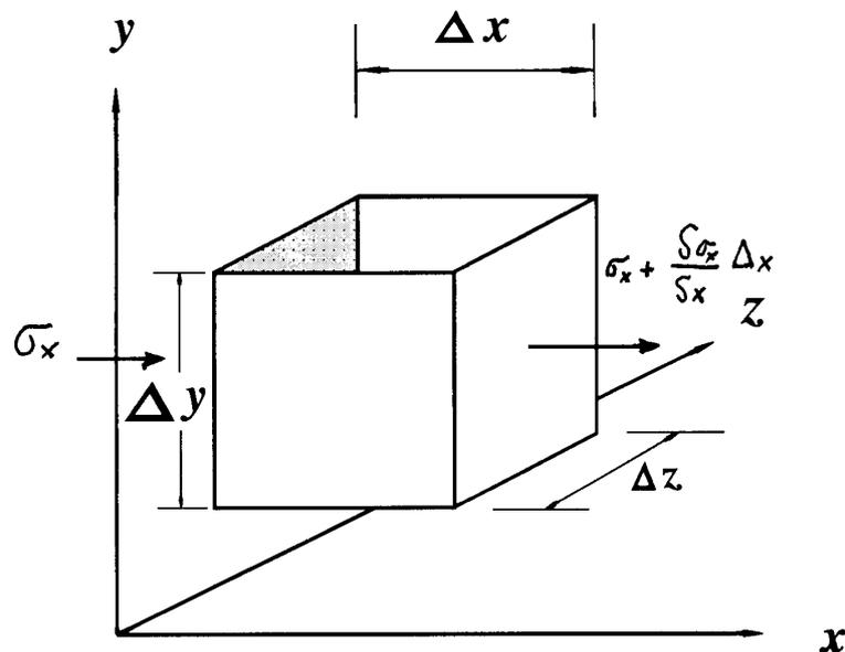
Fig. 2.2 Variazioni dello sforzo normale  $\sigma_x$  sulle due facce parallele distanti  $\Delta x$
