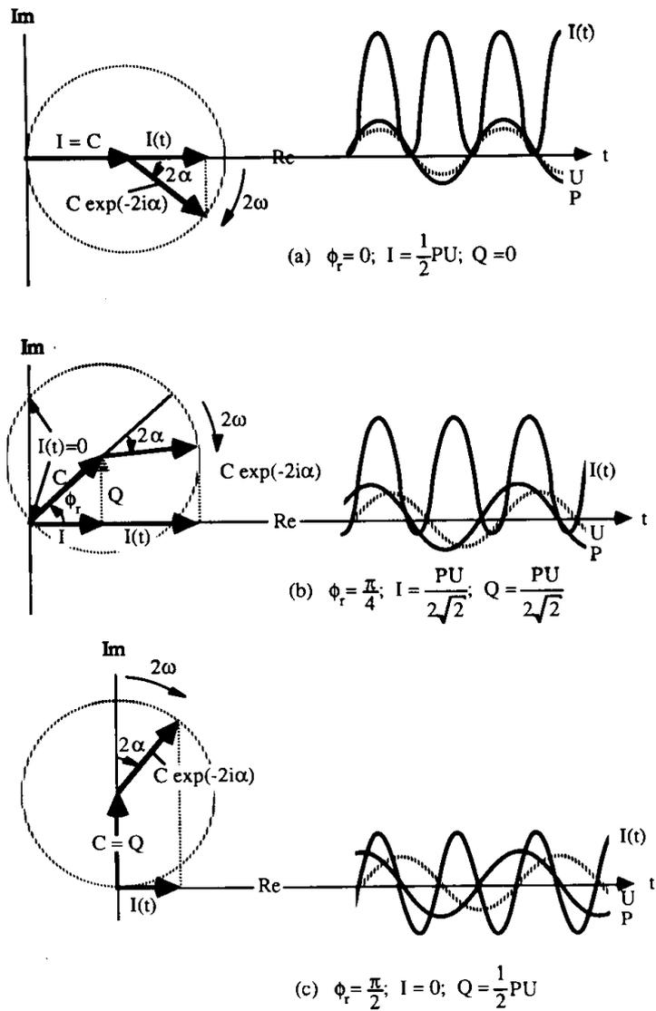
Fig. 3.5 Rappresentazione con i vettori ruotanti dell'intensità istantanea. (I fasori ruotano in senso orario con pulsazione pari a  $2\omega$ .. (F.J.FAHY "Sound Intensity")
