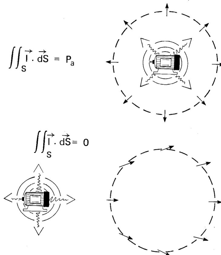
Fig. 5.2 Sorgenti di rumore poste all'esterno della superficie di misura non vengono tenute in conto dal calcolo della potenza sonora: Teorema di GAUSS (Brüel & Kjær Technical review - 1982)
