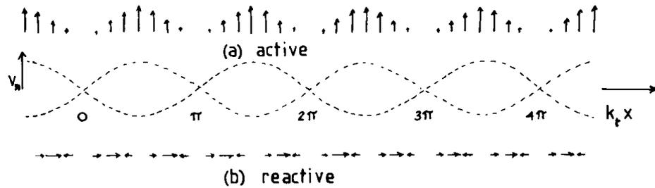
Fig. 3.10 Distribuzione dell'intensità acustica media (a), dell'intensità reattiva (b) in un campo acustico generato da una superficie infinita sede di onde stazionarie. (F.J.FAHY "Sound Intensity")
