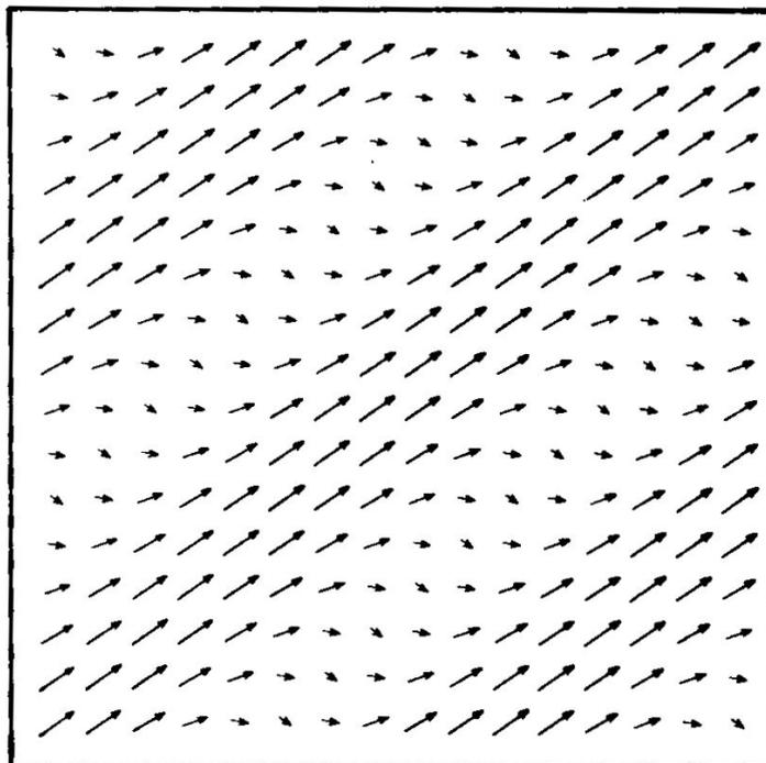
Fig. 3.7 Distribuzione del vettore intensità media in un campo acustico prodotto da due onde piane progressive che si muovono in direzioni ortogonali. (F.J.FAHY "Sound Intensity").
