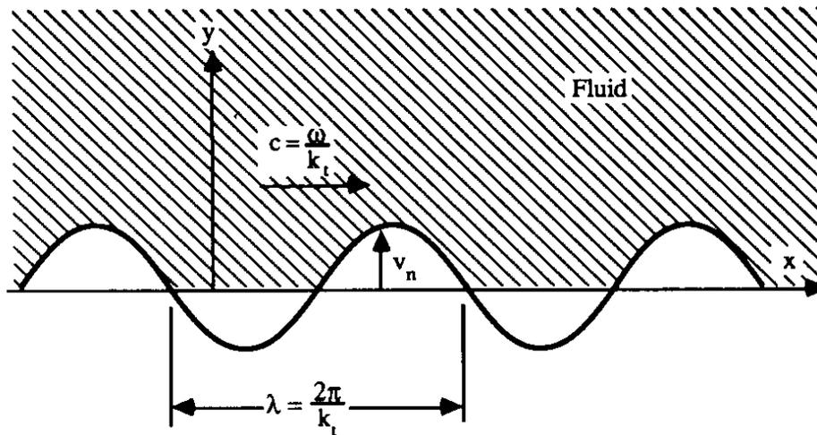
Fig. 3.9 Onda sinusoidale che si propaga nella direzione  $x$  sulla superficie di interfaccia tra due mezzi. . (F.J.FAHY "Sound Intensity")
