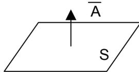
In realtà una sorgente irradia un'onda che si propaga tutt'intorno sotto forma di onde sferiche. A grande distanza dalla sorgente una superficie limitata della sfera può essere ritenuta piana. Nei tubi rigidi infinitamente lunghi e di sezione trasversale costante, l'onda acustica può essere ritenuta piana.
