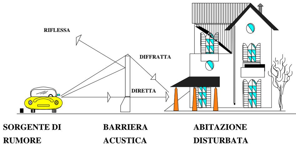
**Fig. 1** - *Abbattimento del rumore mediante barriera acustica*
