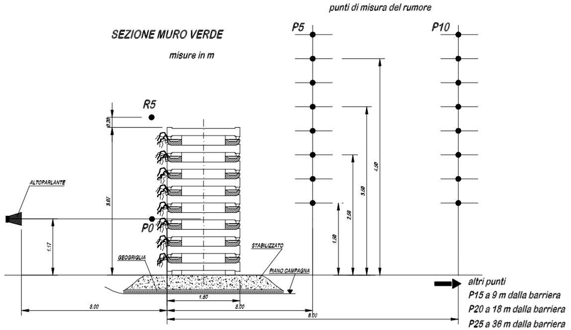
**Fig. 13** - Sezione della barriera acustica Muro verde e disposizione dei punti di misura della perdita di inserzione
