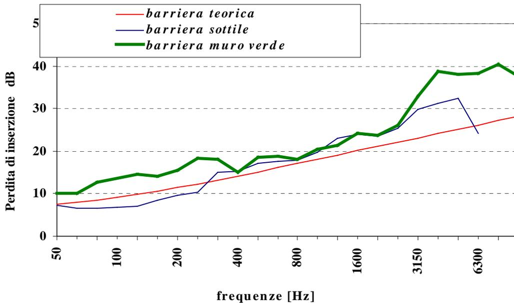
**Fig. 22** - Confronto tra la perdita di inserzione teorica calcolata in P10 e quelle misurate in P10 per la **Barriera sottile** e per il **Muro verde** a 2 m di altezza
