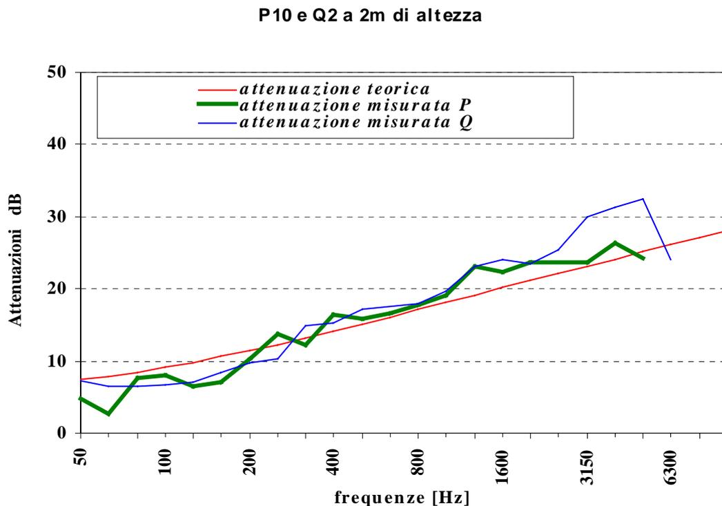
**Fig.20 - Barriera Sottile:** Confronto tra la perdita di inserzione teorica calcolata in P10 a 6 m dalla barriera e quelle misurate scambiando i lati in cui si posiziona l'altoparlante ed i microfoni (punti P10 e Q2) Rilievi a 2 m di altezza.
