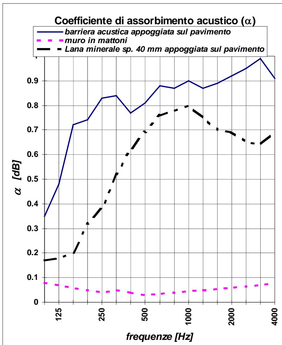
**Fig. 8** - Coefficiente di assorbimento di una barriera metallica con una faccia realizzata con lamiera forata con fori diametro 6mm trama di foratura 40%. Il coefficiente di assorbimento è confrontato con quello di un materassino in lana di vetro spessore 40 mm appoggiato sul pavimento con densità di 16 kg/mc.
