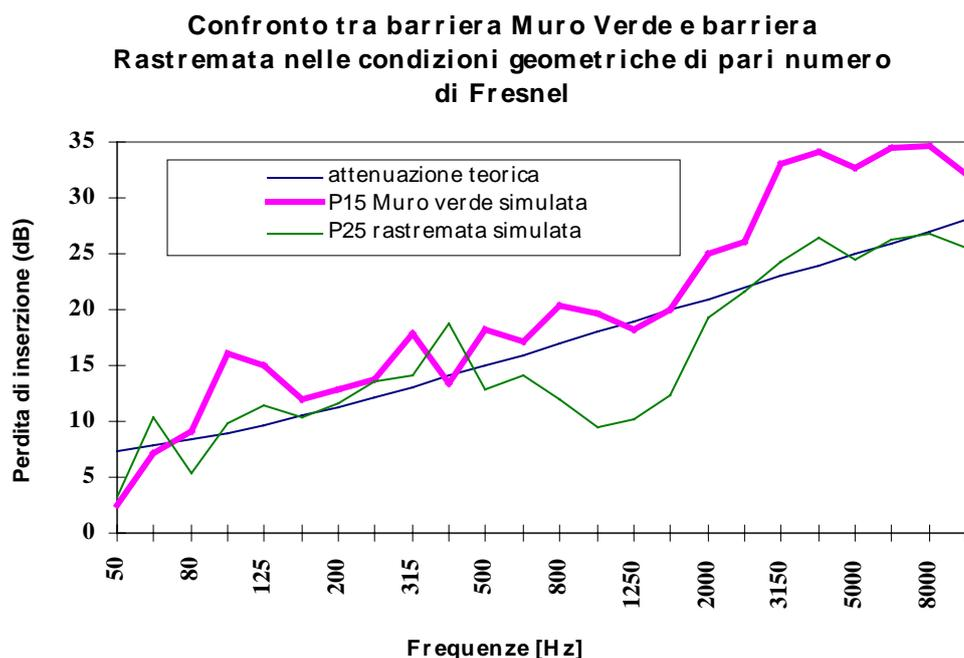
**Fig. 23** - *Confronto tra la perdita di inserzione della barriera rastremata e la barriera muro verde in condizione di similitudine (a pari numero di Fresnel)*
