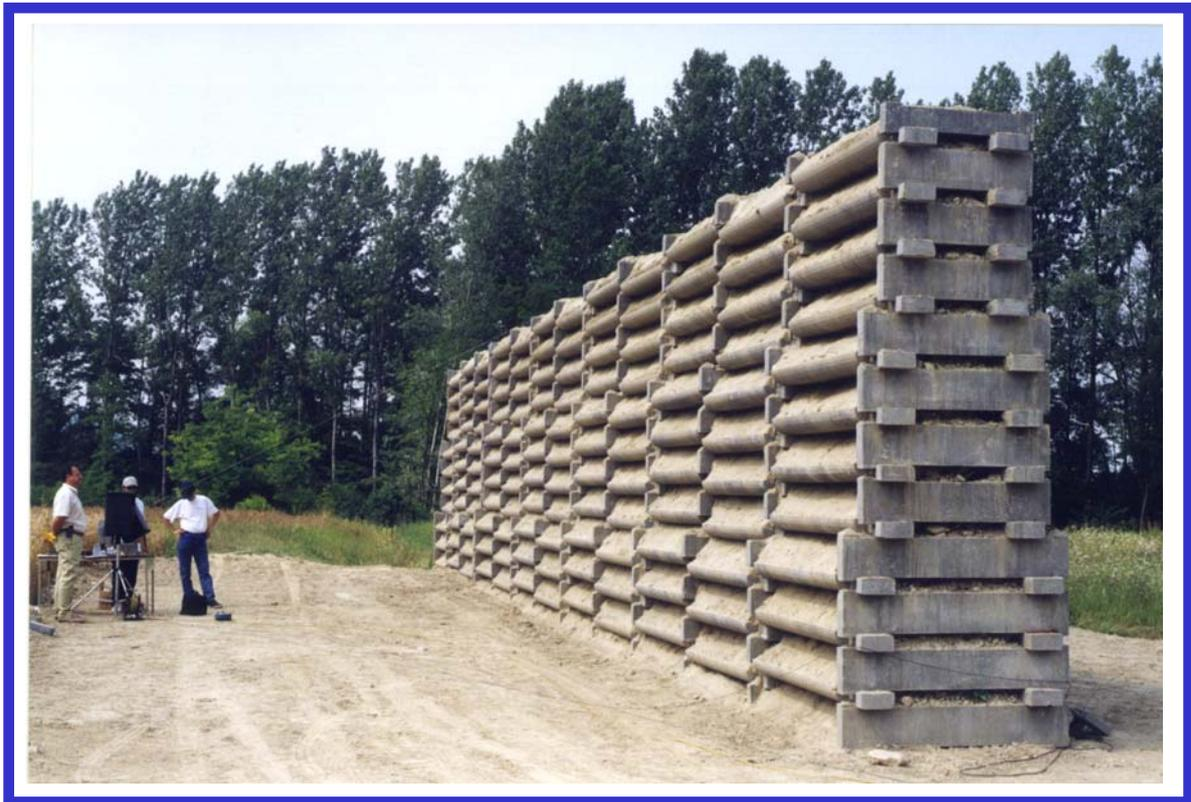
**Sono state condotte sperimentazioni su tre barriere altamente fonoisolanti al fine di determinare la perdita di inserzione in funzione della forma del bordo superiore della barriera**
