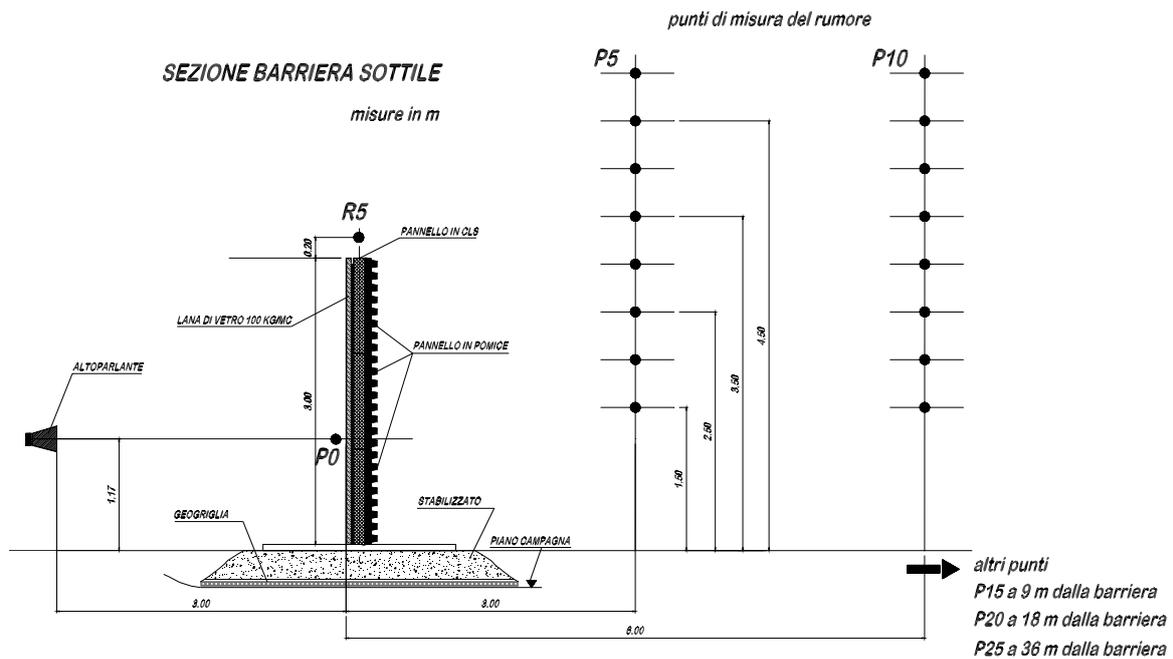
**Fig. 11** - Barriera acustica sottile: composizione e punti di misura della perdita di inserzione.
