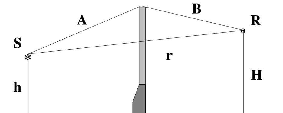
**Fig. 2** - *Calcolo degli abbattimenti di rumore mediante barriera acustica ( $S$  è la posizione della sorgente puntiforme,  $R$  è la posizione del ricevitore).*
