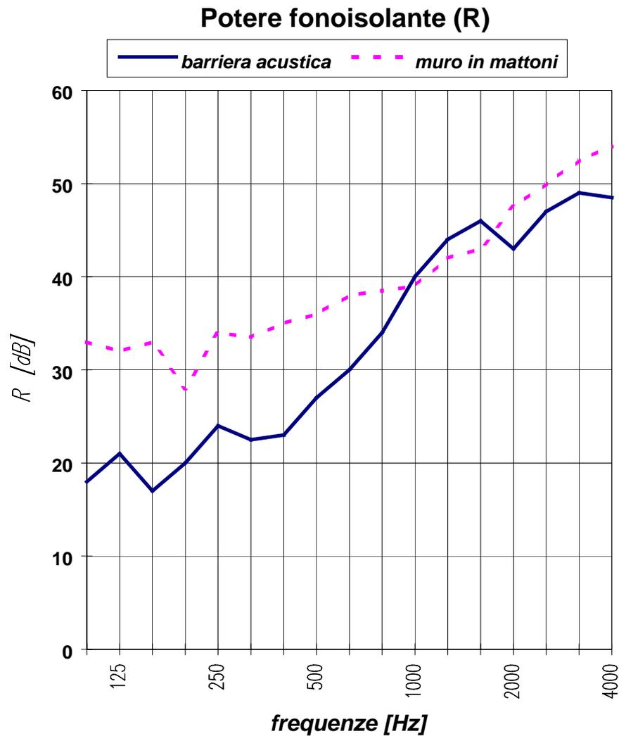
**Fig. 7 .** Confronto tra il potere fonoisolante della barriera acustica e quello del muro in mattoni forati.
