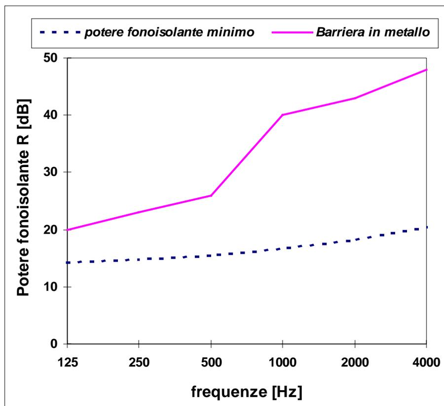
**Fig. 9** - *Confronto tra il valore del potere fonoisolante minimo richiesto nell'esempio ed il valore del potere fonoisolante di una barriera in metallo*
