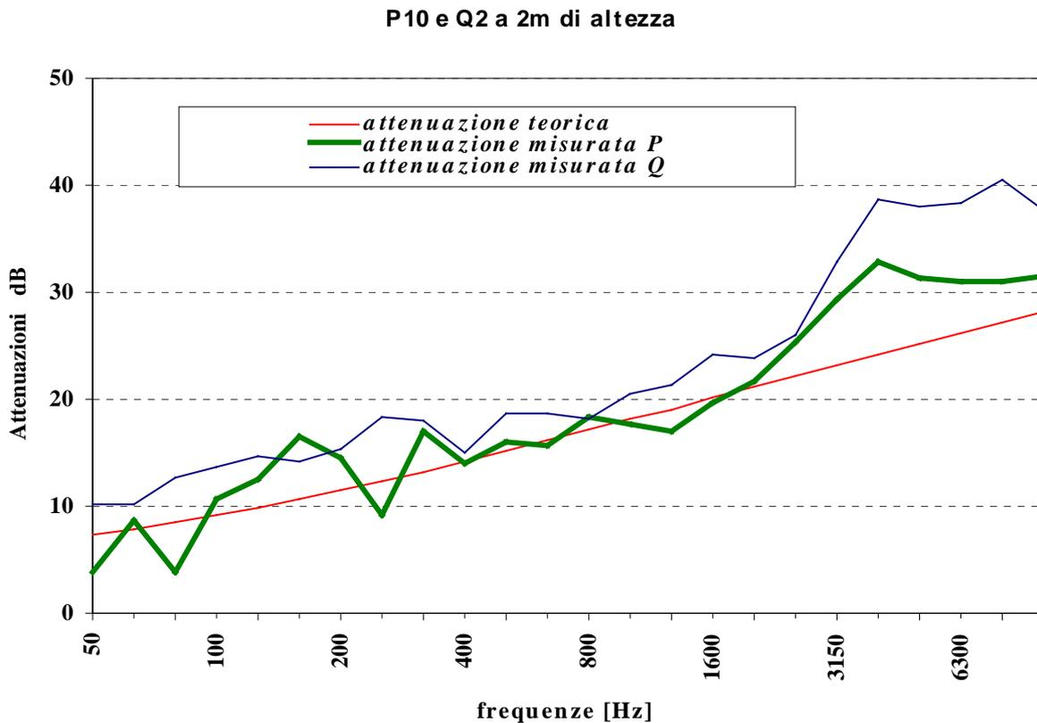
**Fig. 21 - Muro verde:** Confronto tra la perdita di inserzione teorica calcolata in P10 a 6 m di distanza dalla barriera ed all'altezza di 2 m e quelle misurate in P10 e Q2 alla stessa all'altezza di 2 m.
