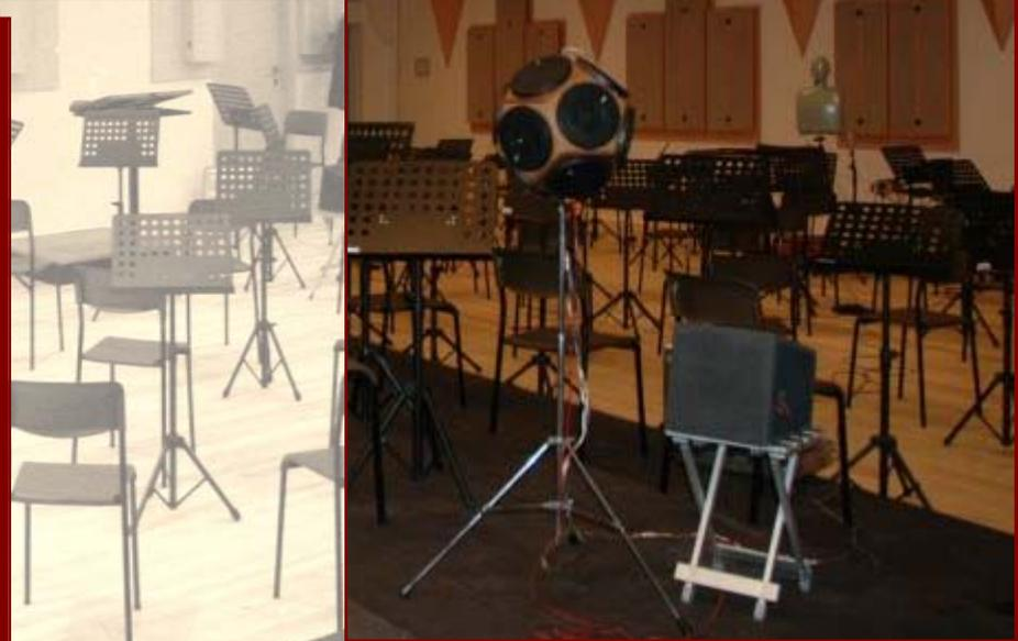
**La testa artificiale utilizzata per la registrazione della prova d'orchestra**
